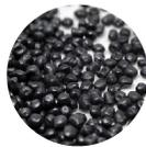
**Plastique.** La ligne d'antenne de l'Apple Watch Ultra 2 sur le boîtier est composée de plastique upcyclé à partir de bouteilles d'eau ayant été transformées en un matériau plus résistant et offrant de meilleures performances.
